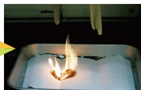
難燃ポリエステルは溶融して垂れた火ダネによって火が燃え広がり、カロンエコは繊維自体が炭化するだけで延焼しません。
